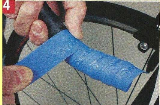
4 Enroulez la guidoline en prenant soin de toujours bien la tendre. Un bon recouvrement positionne la bande de colle sur le cintre, en rive de la guidoline visible. Si la colle est sur le tour précédent, ce n'est pas bon. Si la guidoline est dotée d'un marquage, celui-ci doit rester apparent.
