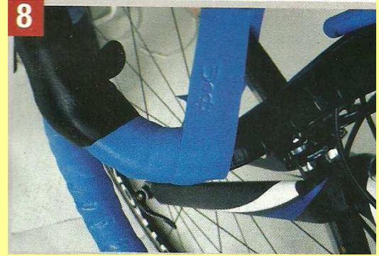
On reprend le rythme de rotation comme en bas, en s'appliquant à être le plus régulier possible et en veillant au bon recouvrement dans les arrondies. Ce point est délicat, car la courbure du cintre est très prononcée. L'erreur la plus souvent commise est d'avoir un recouvrement insuffisant de la guidoline sur l'arrière du cintre.
