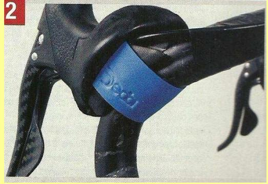
2 Premier épisode, on relève les caoutchoucs des cocottes pour disposer un morceau de guidoline sur la fixation de la cocotte. En le faisant avant de commencer, on évite de devoir lâcher la guidoline en cours de route, avec le risque qu'elle ne se décolle sur une bonne partie de sa longueur.
