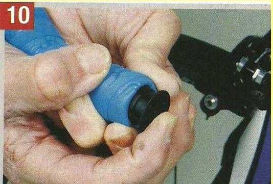
En bas du cintre, on place le bouchon après avoir rabattu le surplus de guidoline à l'intérieur de cintre. Attention, cette phase est délicate car le bouchon doit vraiment être bloqué pour ne pas se faire la belle au premier nid de poule. Par conséquent, le rentrer vraiment en force, voire avec un petit maillet est plutôt une bonne chose.
