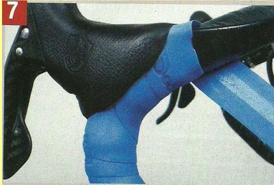
On fait le tour de la cocotte, en passant au plus près dessus et en s'assurant que le petit morceau préalablement disposé est bien en place et suffisamment recouvert. On rabat ensuite le caoutchouc pour vérifier que le cintre n'est pas visible. Généralement, les problèmes se situent sur le devant, au dessus de la cocotte. Si c'est le cas, on recommence.
