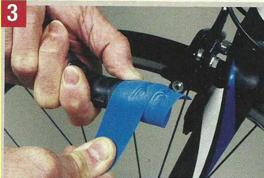
3 Décollez le film de protection sur environ 20 cm et placez le ruban de façon à ce que la moitié de sa largeur dépasse du bout du cintre. Enroulez d'une main, en tenant l'extrémité de la guidoline de l'autre, afin d'éviter qu'elle ne se décolle. La guidoline doit être tendue, mais pas trop, pour ne pas la fragiliser. Au bout de deux tours, vous pouvez lâcher l'extrémité.
