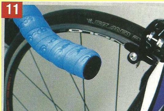
La pose terminée, on vérifie qu'aucun morceau de guidoline ne dépasse du bouchon et que celui-ci soit bien bloqué. Si ce n'est pas le cas, pour éviter de tout recommencer, enroulez du ruban adhésif autour de la partie du bouchon qu'on insère dans le cintre, pour faire une surépaisseur qui maintiendra le bouchon en place
