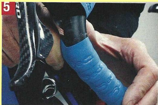
5 Dans la courbure du cintre, il faut bien vérifier que la partie « extérieure » de la guidoline (sur l'avant du cintre) recouvre suffisamment celle du tour précédent. Pour cela, il faudra sans doute resserrer le rythme de rotation et, cette fois, positionner la colle sur la guidoline du tour précédent. C'est encore plus vrai avec un cintre compact dont le cintrage est très prononcé.
