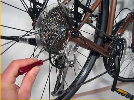
Pour commencer, positionner le dérailleur pour que la chaîne soit sur le grand pignon. Cette position permettra de régler la distance entre les dents du pignon et le galet de guidage
