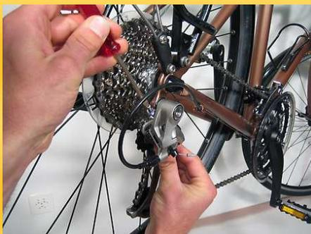
Si au contraire l'écart entre le pignon et le galet est trop petit, il y a risque que ce dernier touche le pignon. Pour augmenter cet écart, tourner la vis dans le sens des aiguilles d'une montre
