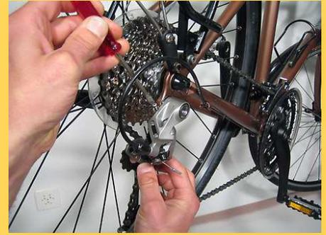
Si l'écart entre le pignon et le galet est trop grand, les changements de vitesse manqueront de précision. Pour le réduire, tourner la vis dans le sens inverse des aiguilles d'une montre
