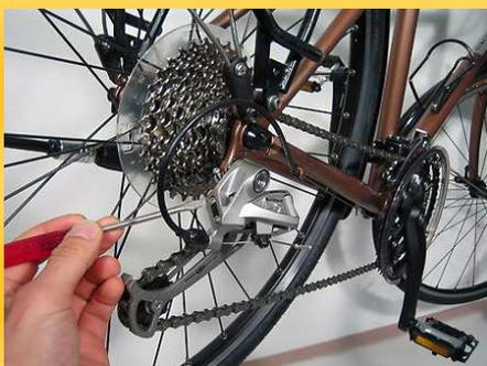
Cette position permet de régler la butée du dérailleur pour les hautes vitesses à l'aide de la petite vis marquée d'un H
