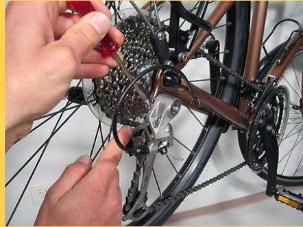
Le réglage de cette distance se fait avec une petite vis qui prend appui sur le cadre et permet ainsi un ajustement angulaire du dérailleur autour de son point de fixation
