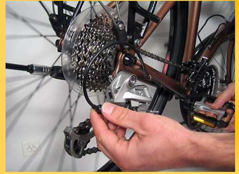
Contrôler maintenant le changement des vitesses en tournant les pédales et en positionnant la chaîne sur le pignon du milieu. Pour les levier de vitesses indexés, attention à bien être sur le bon numéro de pignon. Le galet du dérailleur doit être aligné avec le pignon. Régler si besoin avec l'ajusteur en tournant vers la gauche ou vers la droite
