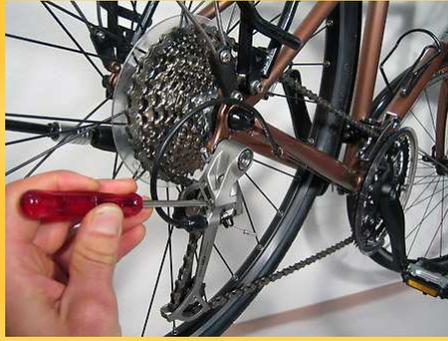
Si la chaîne va trop loin contre les rayons, tourner la vis dans le sens anti-horaire. Si elle ne veut pas passer sur le grand pignon, tourner la vis dans le sens des aiguilles d'une montre
