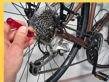
Si au changement de vitesse la chaîne peine à passer sur le petit pignon, tourner la vis dans le sens anti-horaire et si elle descend trop bas tourner la vis dans le sens des aiguilles d'une montre
