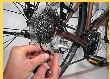
Lorsque le réglage est bon, il ne devrait pas y avoir de tension dans le câble et la chaîne doit se placer avec précision sur le petit pignon. Libérer la tension du câble en tournant l'ajusteur dans le sens des aiguilles d'une montre
