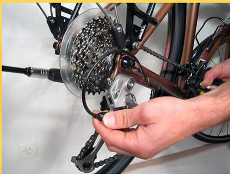
Au besoin, ajuster encore le passage d'une vitesse à l'autre en tournant légèrement l'ajusteur vers la gauche ou vers la droite
