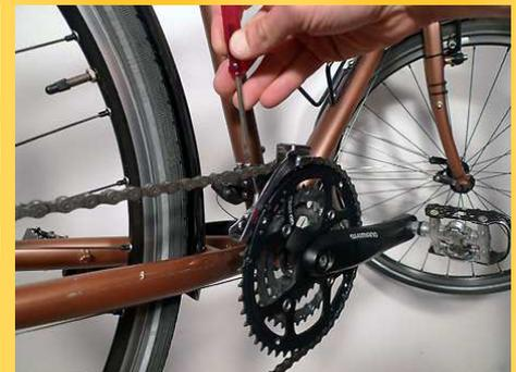
Régler la vis marquée d'un H dans le sens horaire si la chaîne déraille, dans le sens inverse si vous n'arrivez pas à la monter sur le grand plateau.
