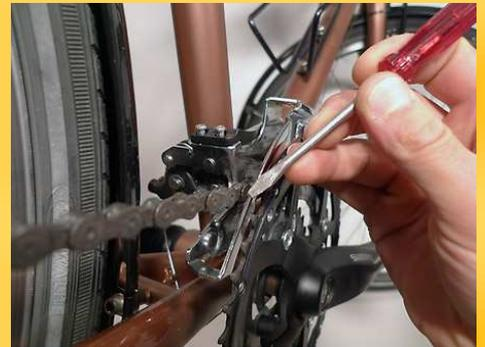
Si la chaîne touche la cage du dérailleur, tourner la molette de la manette jusqu'à ce que le frottement disparaisse tout en laissant un espace aussi petit que possible entre la chaîne et la cage.
