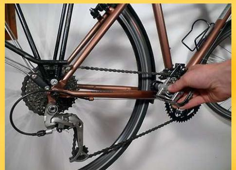
Il ne reste plus qu'à contrôler le passage des vitesses d'un plateau à l'autre tout en s'assurant que la chaîne ne touche pas la cage en déplaçant le dérailleur arrière du plus grand au plus petit pignon, et inversement. Voilà!
