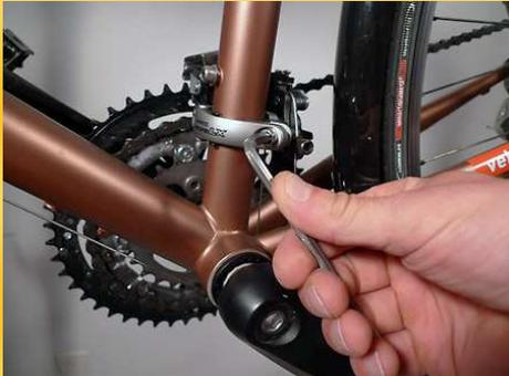
Pour commencer, il va falloir régler la position du dérailleur sur le cadre. Placer la chaîne sur le plateau du milieu puis desserrer la vis de serrage de la bride du dérailleur.
