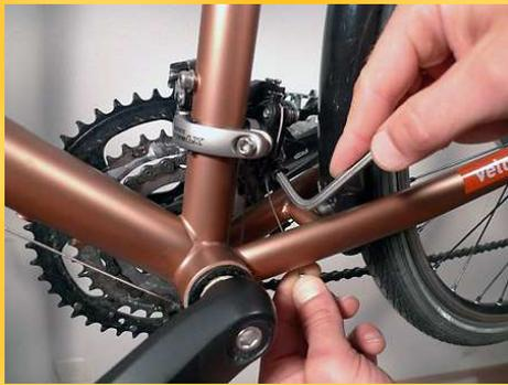
Le câble bien libéré, tirer dessus avec les doigts pour le tendre, puis resserrer la vis de blocage en maintenant le câble tendu.
