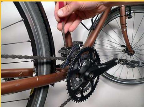
Régler la vis de butée marquée d'un L en tournant dans le sens des aiguilles d'une montre si la chaîne déraille, dans le sens inverse si vous n'arrivez pas à la descendre sur le plus petit plateau.
