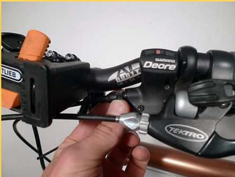
Le réglage final du dérailleur, qui consiste à éliminer les frottements de la chaîne sur la cage de dérailleur, se fait avec la vis de réglage au niveau de la manette.
