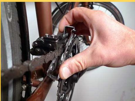
Régler ensuite l'orientation de la cage. Elle doit présenter un défaut d'alignement avec le grand plateau de 1-3 mm vers l'extérieur au niveau de la partie basse (sous le pouce).
