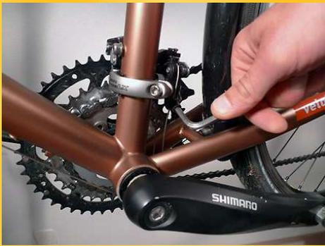
Les butées étant ajustées, on va pouvoir régler le placement du dérailleur. Pour commencer, mettre la chaîne sur le petit plateau puis desserrer la vis de blocage du câble.
