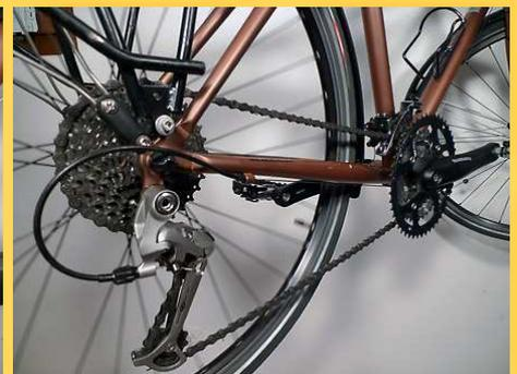
L'étape suivante consiste à régler les butées qui permettent d'éviter que la chaîne ne déraille lors des changements de vitesses. Placer la chaîne sur le grand pignon (AR) et le petit plateau (AV).
